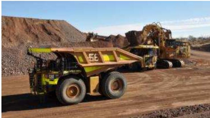
Hình 3. Xe ô tô tự lái của hãng Caterpillar đang vận tải đất đá mỏ tại Úc
