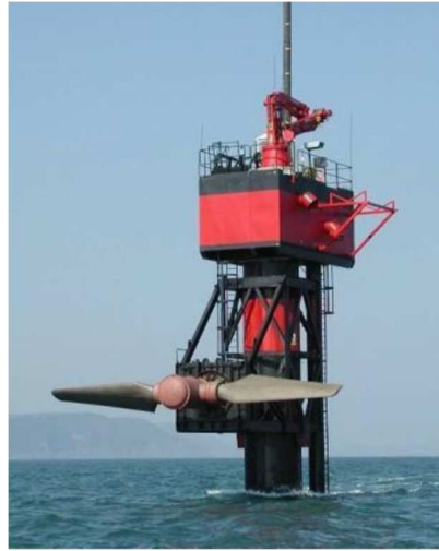
Hình 2. Thiết bị chuyển đổi năng lượng của dòng chảy triều thành điện năng- Tuabin thủy triều
